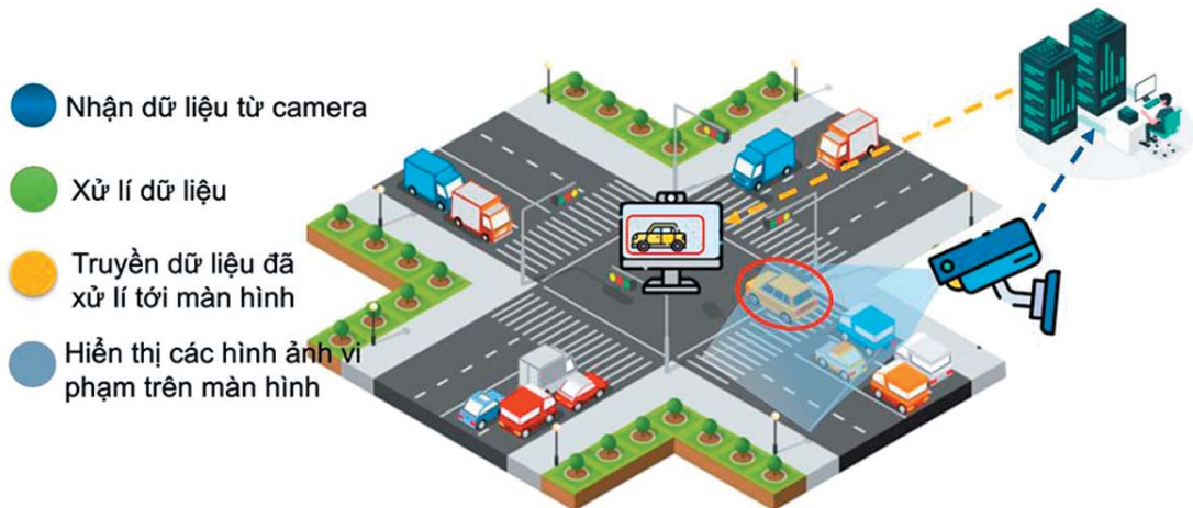
Mô phỏng hệ thống phát hiện vi phạm vượt đèn đỏ bằng việc ứng dụng AI. Ảnh: NVCC
